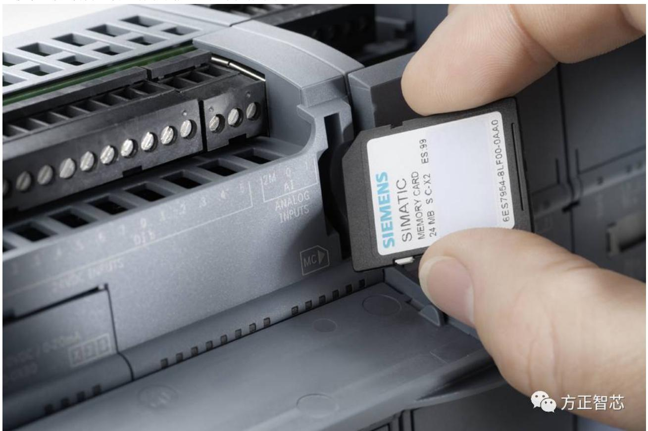
S7-1200 PLC的存储卡有三种功能：
