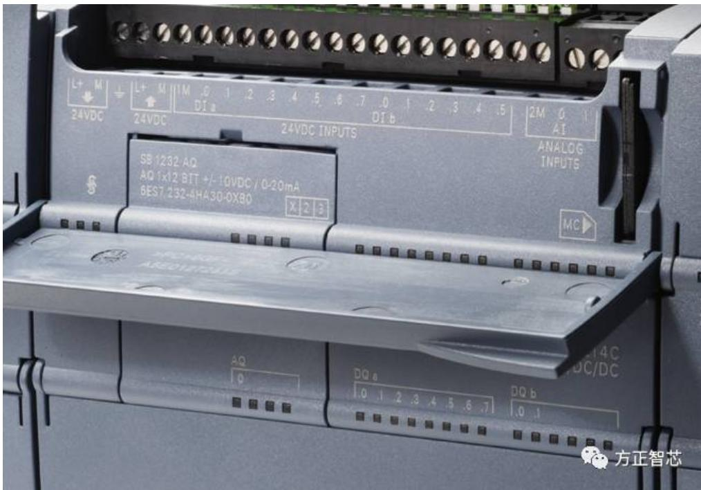
左边三个端子X10:1/2/3为CPU供电接线端子：
