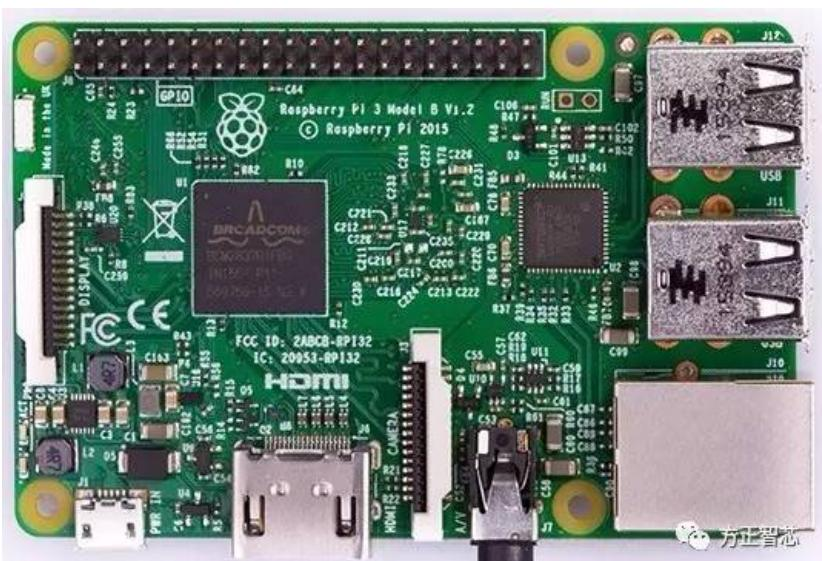
与第二代产品相比，三代机采用了ARM V8的四核64位CPU，其工作频率可达1.2G Hz；内置802.11n无线网卡；内置蓝牙4.1及低功耗蓝牙；其它方面与二代B型机相同（比如：1G内存；4个USB；40个编程针脚；
