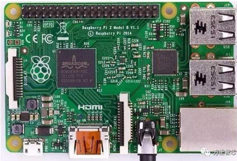
二代B型机使用了ARM A7四核CPU，主频900MHz；系统内存（RAM）增加至1G；其它方面与一代B+型相同。时隔一年，2015年年底，树莓派官方推出了第三代B型机，并于2016年2月取代了二代B型机。三代B型机如下图：
