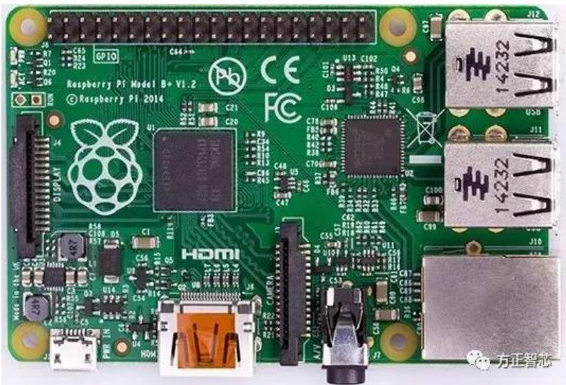
与B型机相比，B+型号的编程接口增加至40针；取消了RCA视频接口；USB接口增加至4个；用微型SD卡（Micro SD）取代了原来的标准SD卡；有更低的系统功耗。在CPU、内存、HDMI等其它方面与B型机保持一致。
