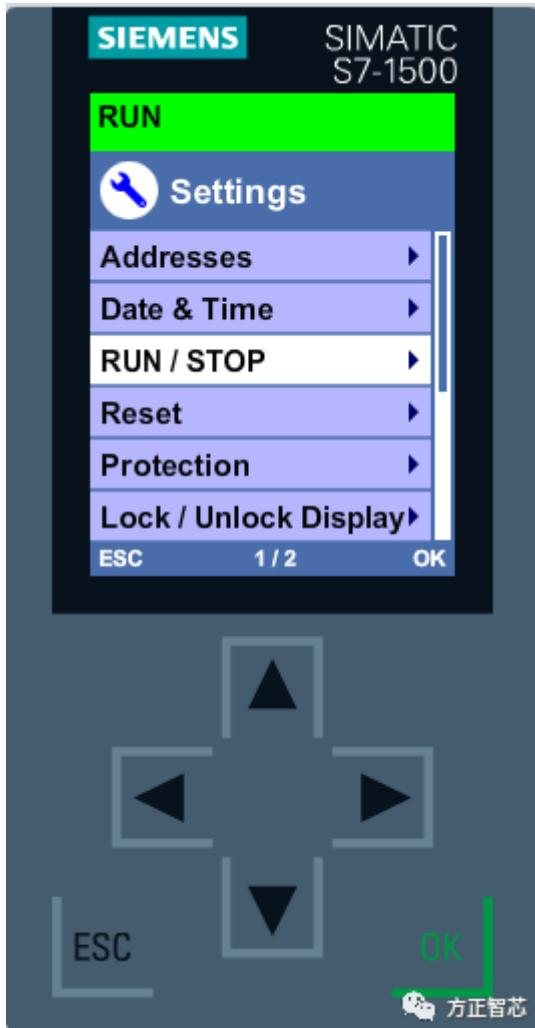
3.系统会提示你是否真的要将CPU设置成“停机 (STOP) ”模式，点击“确认 (OK) ”；
