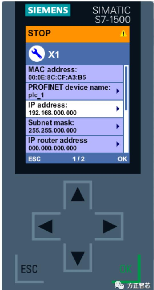
5.再次点击“OK”键，“IP地址 ( IP Address )”菜单进入编辑状态。利用方
