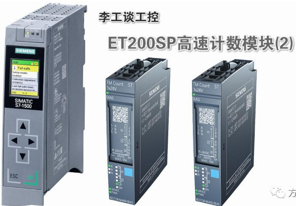
本例程使用CPU 1515-2 PN和ET200SP组建Profinet网络，TM Count在ET200SP中。
